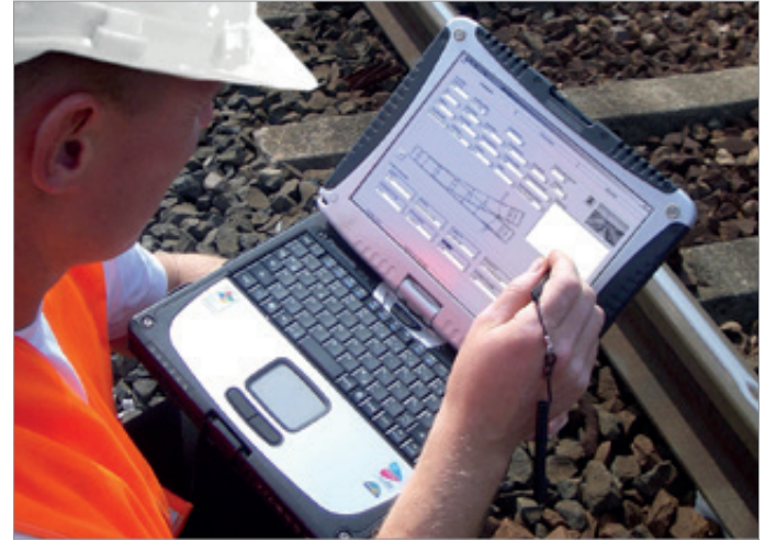
MR.pro® im Einsatz als Expertensystem bei der Bestands- und Zustands-erfassung im Gleis. Das Foto entstand im Jahr 2005 mit der damals aktuellen Toughbook-Technik.
